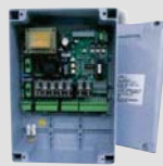
Armoire de commande
