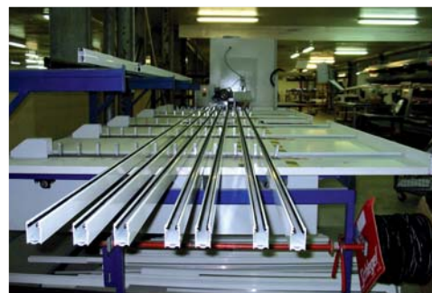
Machine de débit et perçage automatique de coulisses
